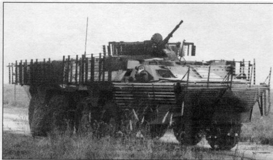
БТР-80 с установленным комплектом противокумулятивной защиты в виде решетчатых экранов монтируемых на корпусе. Комплект разработан в Московском НИИ Стали.
